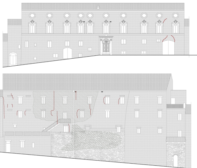
Riparazione danni, risanamento conservativo Palazzo Giustiniano di Monte Rinaldo.
